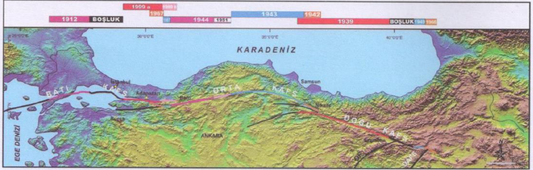
Şekil 3. Kuzey Anadolu Fayı'nın genel geometrisi ve 20. yüzyılda üzerinde meydana gelen büyük depremler. 1939 ile 1999 arasında batıya doğru göç eden ve her bir depremde yüzlerce kilometre uzunluğunda yüzey faylanması gelişen bir deprem serisi meydana gelmiştir. 1943 Lâdik depremi KAF'nın orta kesiminde gelişmiştir.
